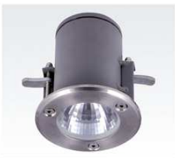
型号: ST-4201 FG磨砂玻璃 CG清玻璃 灯脚: G4 光源: QT12 12V 35W/50W 材质: 铝质 不锈钢 颜色: Black 黑色 White 白色 Silver Grey 银灰色 规格: Ø83mm x H95mm 开孔: Ø72mm
