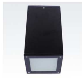
型号: ST-4110 FG磨砂玻璃 CG清玻璃 灯脚: G12 光源: CDM-T 35W/70W 材质: 铝质 颜色: Black 黑色 White 白色 Silver Grey 银灰色 规格: \text{L}150\text{mm} \times \text{W}150\text{mm} \times \text{H}270\text{mm}
