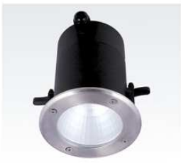
型号: ST-4203 FG磨砂玻璃 CG清玻璃 灯脚: G8.5 光源: CDM-TC 35W/70W 材质: 铝质 不锈钢 颜色: Black 黑色 White 白色 Silver Grey 银灰色 规格: Ø115mm x H140mm 开孔: Ø104mm
